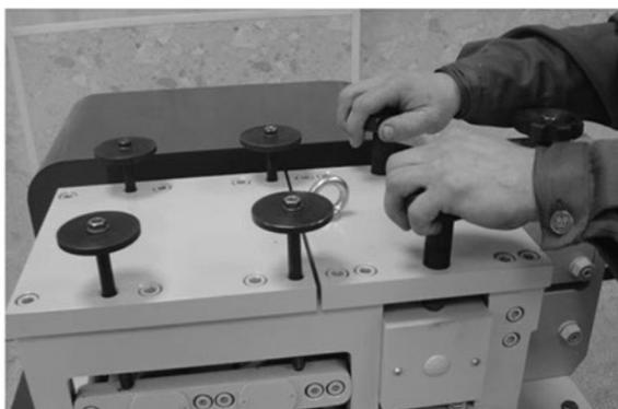
**8.2.3.** Ввести заготовку между роликами направляющего устройства, завернуть регулировочный винт с таким расчётом, чтобы заготовка свободно перемещалась в продольном направлении, но была зажата без люфтов в поперечном
